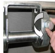
2. Tirer sur la tête de serrage pour désengager le mécanisme.
