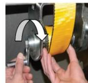
5. Pousser la tête de serrage en tournant dans le sens horaire pour engager le mécanisme.
