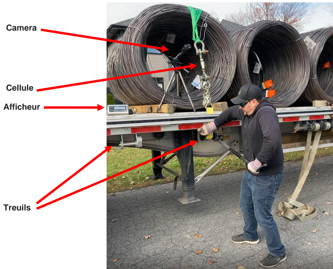
Figure 6. Disposition du montage pour les différents équipements de mesure
