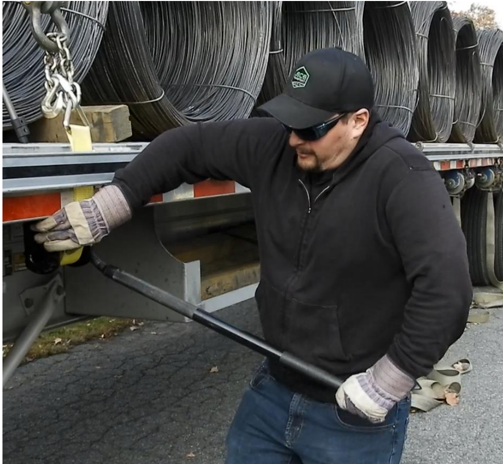
Figure 18. Posture utilisée par le travailleur lors du déverrouillage du treuil TRADITIONNEL
