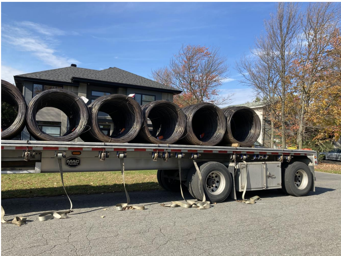
Figure 5. Remorque utilisée de type plateforme du fabricant MAC
